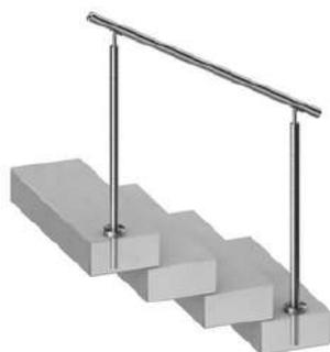
**betoniert | aufgesetzte Handlaufstütze**
