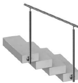
**seitlich | aufgesetzte Handlaufstütze**
